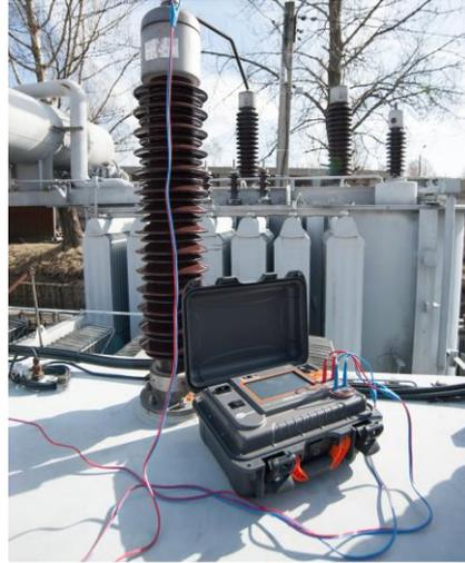
電感性線圈量測
