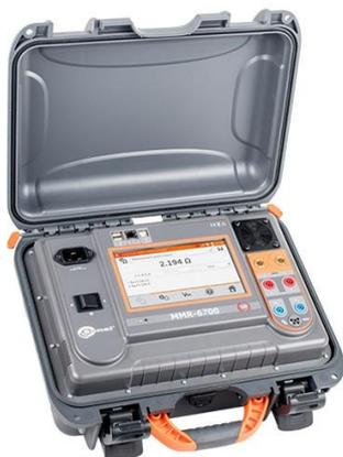
**簡介:**高精度可攜式大電流低阻計，量測電流最高到 100A(MMR6500)及 200A(MMR6700)，並具有 10A 放電可量測帶電感性之負載電阻，例：「變壓器線圈」，8 吋 TFT 彩色螢幕清晰方便觀看、內建電池可長時間測試 3.5 小時(限輸出電流 10A，才可採用電池供電)。
