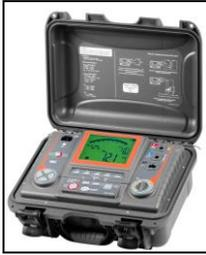
**簡介：**測量絕緣電阻高達  $15T\Omega$ ，依據 EN-61326 可抗高電壓雜訊之干擾，例如：745kV 變電站保持測量穩定，並能作絕緣測試分析及計算極化指數(PD)、介質吸收率(DAR)、介電質放電計算(DD)。
